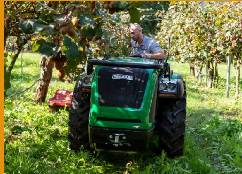
Il Thor 85 AR monta il brillante motore diesel 4 cilindri Kohler KDI 2504 TCR di 2482 cm 3 e potenza di 75 CV
